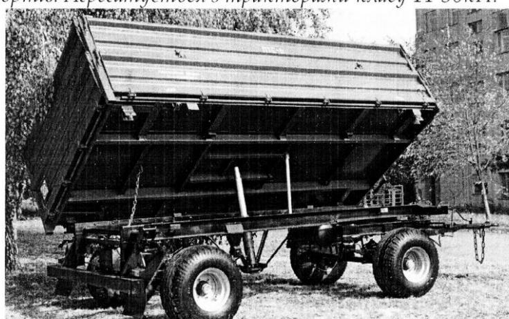
**ПРИЧІП ТРАКТОРНИЙ ПТС-8** вантажопідйомністю 8т, підсилена версія причепа ПТС-6.
