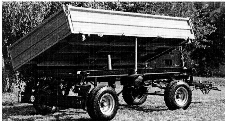
**ПРИЧІП ТРАКТОРНИЙ ПТС-6** вантажопідйомністю 6т, особливістю причепа є його універсальність, яка забезпечується оригінальною конструкцією двохярусних бортів. Агрегатується з тракторами класу 14-30кН.
